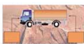
Vehículo de carga general con dos o más mercancías peligrosas de diferentes clases o división.
