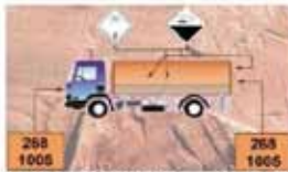
Unidad de transporte (tanque o de carga general) cargada con una única mercancía peligrosa, que exige una etiqueta de riesgo principal y otra de riesgo secundario.
